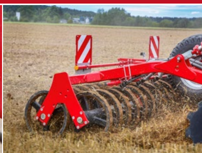
Според работната ширина до 12 извода се грижат за равномерно надлъжно разпределение на семената
