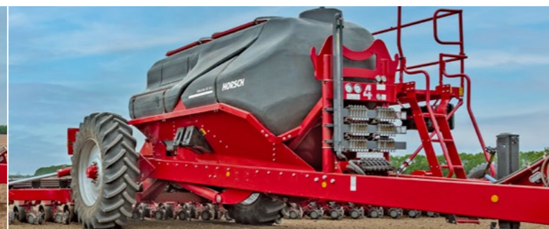
Индикатор за ниво и индикатор за поток RedBall на резервоара за течен тор
